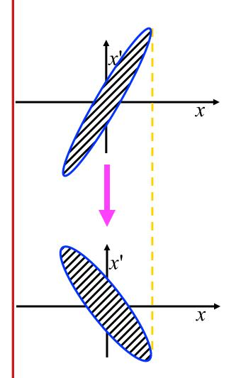
$$\begin{pmatrix} \beta & -\alpha \\ -\alpha & \gamma \end{pmatrix} = \begin{pmatrix} 1 & 0 \\ -k & 1 \end{pmatrix} \begin{pmatrix} \beta_0 & -\alpha_0 \\ -\alpha_0 & \gamma_0 \end{pmatrix} \begin{pmatrix} 1 & -k \\ 0 & 1 \end{pmatrix}$$
